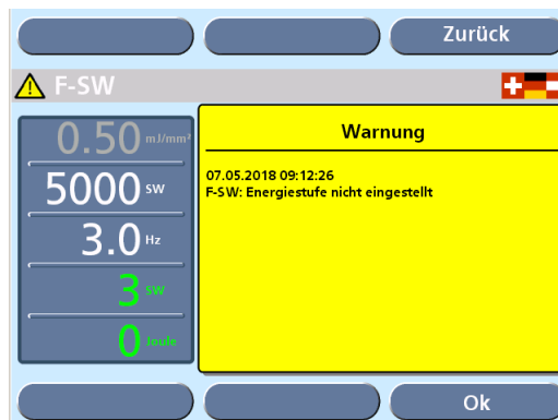
Bild. 5-19 Energiestufe nicht eingestellt
