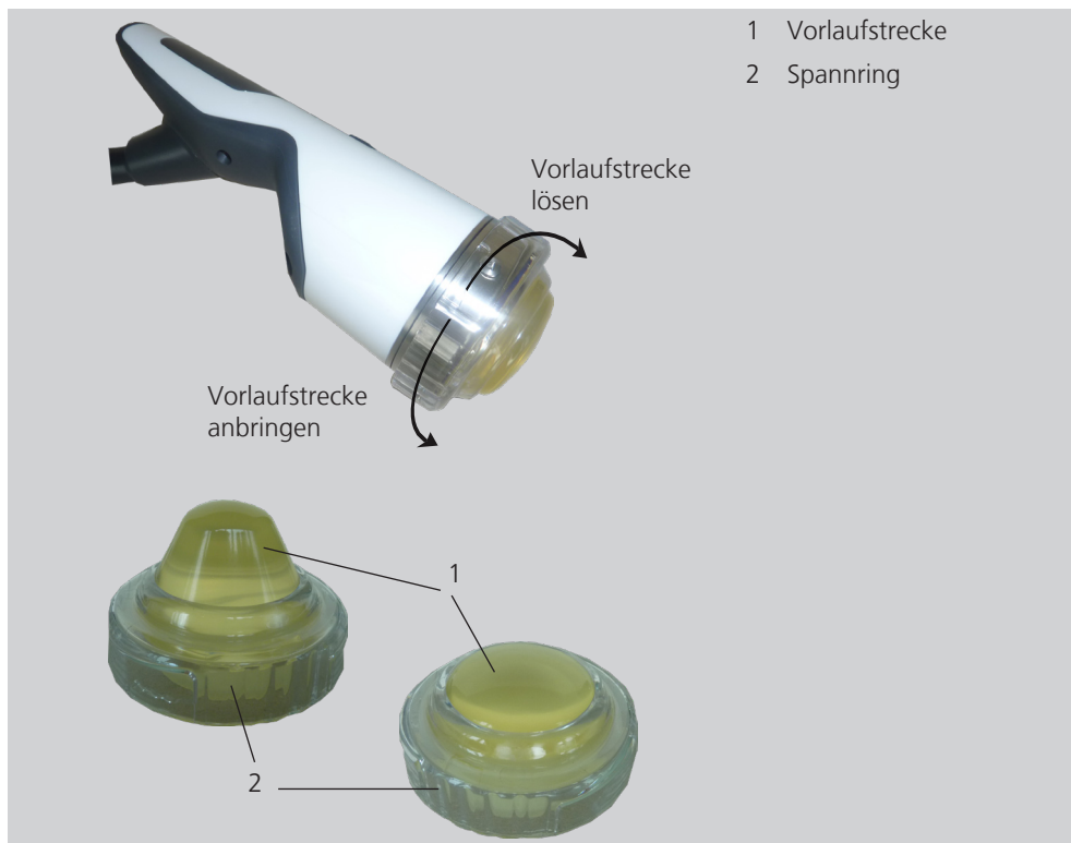
Bild. 6-50 Montieren der Vorlaufstrecken
